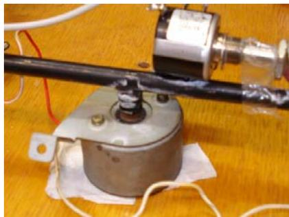
**Fig. 18:** Motor de toca-discos, substituindo o motor apresentado na seção Materiais e Métodos.
