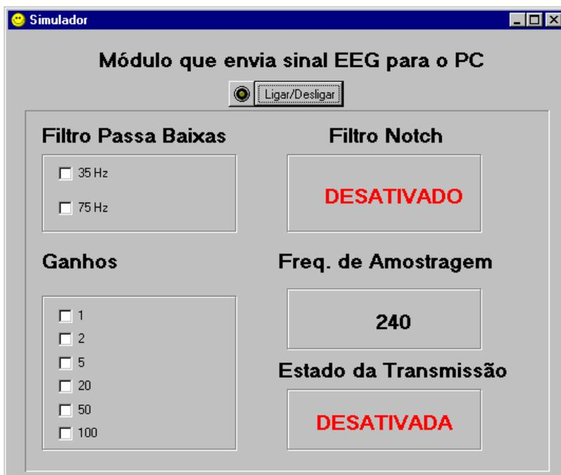
Figura 5.2 – Tela do *software* de simulação do *hardware*.
