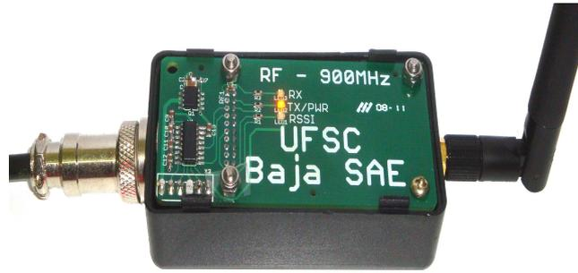
Figura 41: Transceptor do veículo em operação
