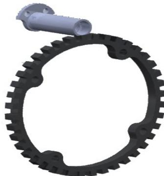
*Figura 5: Sensor de velocidade e roda fônica.*
