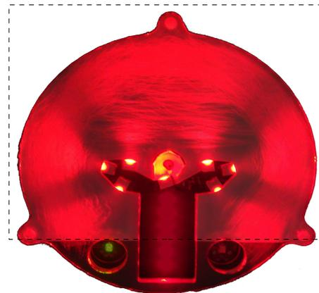
Figura 48: Guia de luz, leds e filme refletor funcionando.
