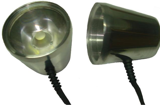
*Figura 32: Faróis montados e utilizados nos Bajas.*
