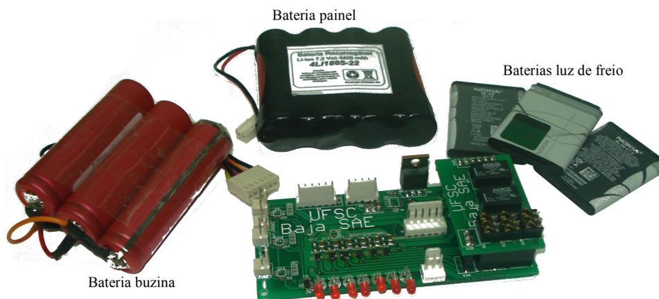
*Figura 35: Baterias e placa contendo carregadores*
