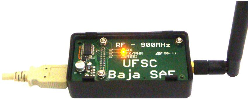
*Figura 44: transceptor PC montado e funcionando*
