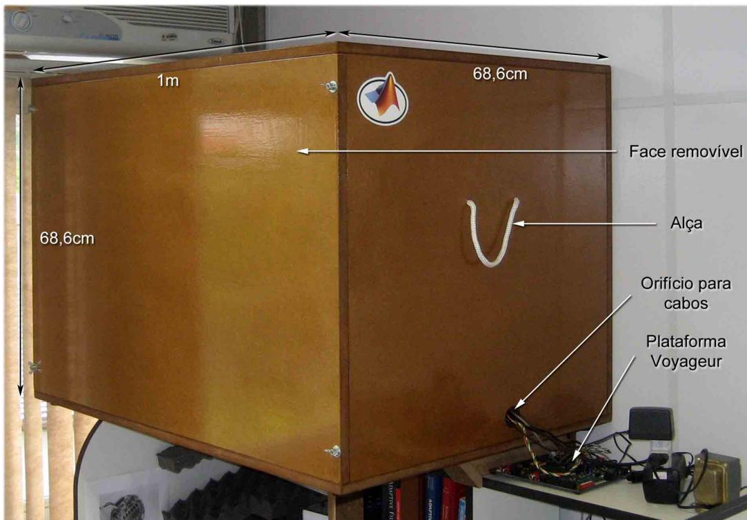
Figura 3.5: Câmara acústica para testes conectada ao módulo Voyageur.
