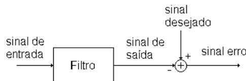
Figura 3: Esquema de um processo de filtragem e criação de um sinal de erro.
